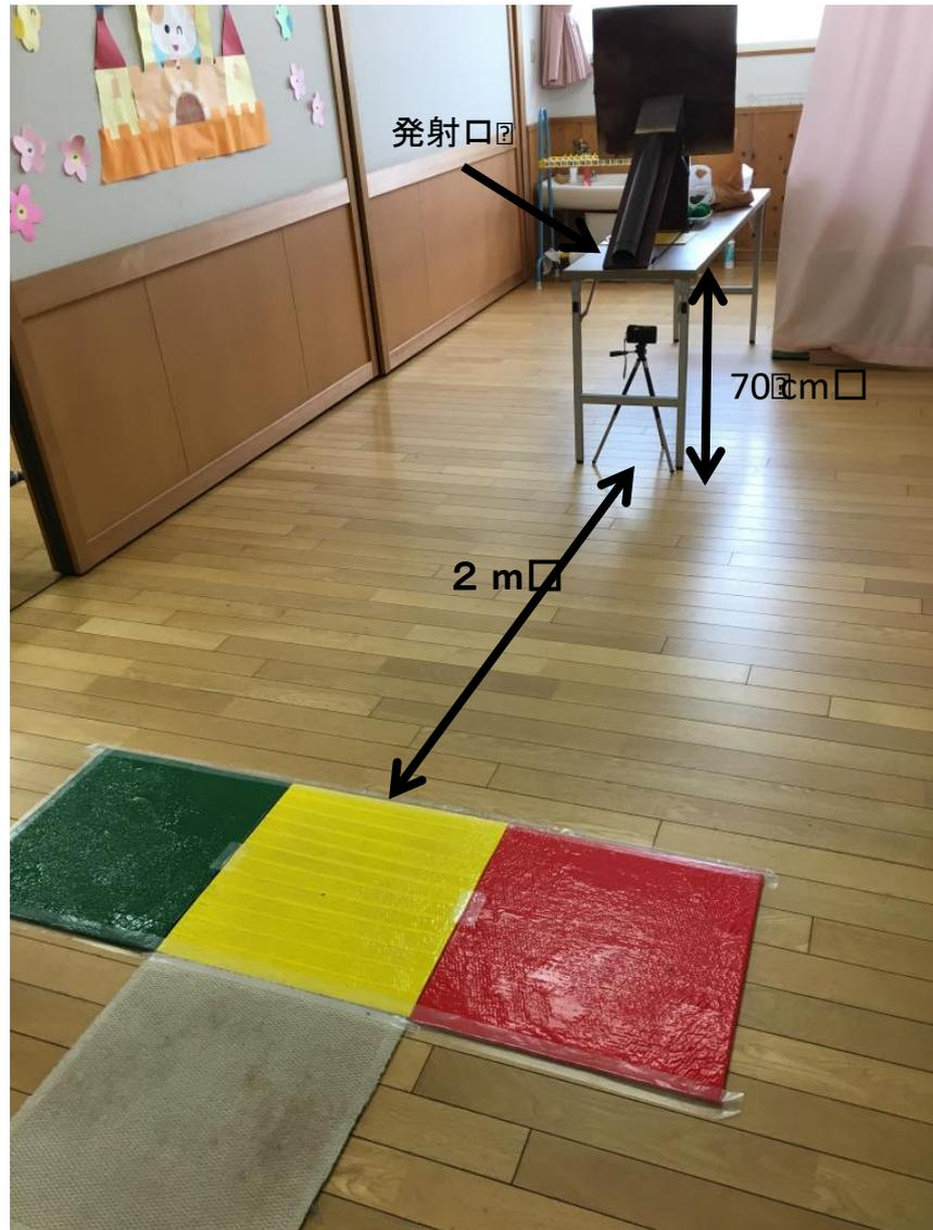
写真5 キャッチorエスケープテストの測定配置図
